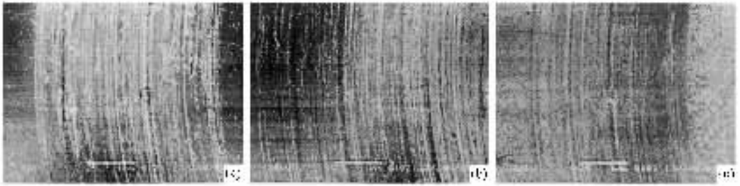
图5 为复合镀层磨损后磨损表面磨痕的 SEM 像(×25) (a)Ni-P (b)Ni-P-SiC (c)Ni-P-CNTs
