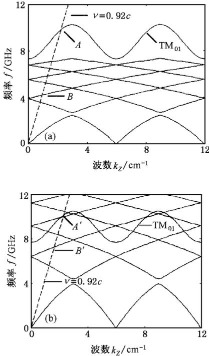
图 2 无限薄环形等离子体填充波纹波导的冷色散关系
