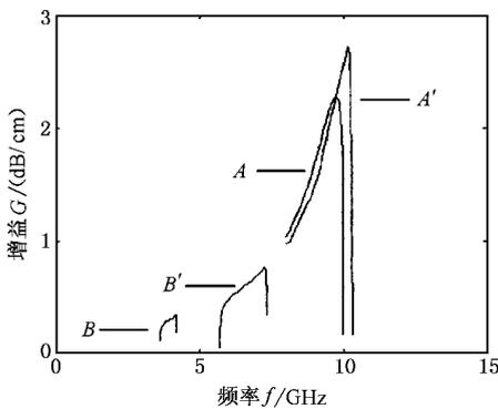
图 3 在图 2 所示的四个同步点处, 行波管单位长度上的小信号增益随频率的变化关系
