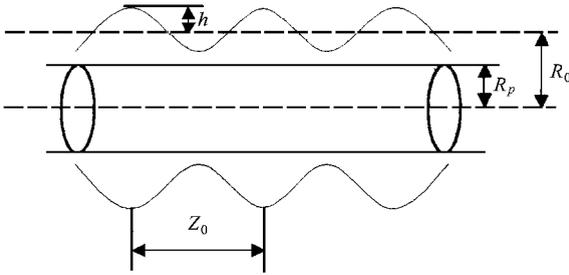
图 1 薄环形等离子体填充波纹波导结构示意图
