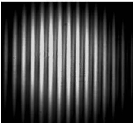
图 7 三路相干合成时长期曝光远场图样
