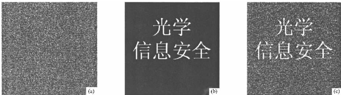
图 5 二值图像的模拟实验结果 (a)后续传来的密文 (b)相应的原来的明文 (c)运用攻击所得的会话密钥解密出来的结果
