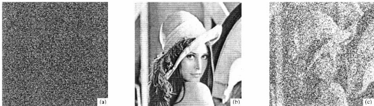
图 4 灰度图像的模拟实验结果 (a)后续传来的密文 (b)相应的原来的明文 (c)运用攻击所得的会话密钥解密出来的结果
