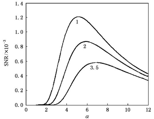
图 4 信噪比作为  $\alpha$  的函数随着非对称  $r$  变化的曲线( $a=b=1, A=0.1, D=4, \lambda=0.3$ )
