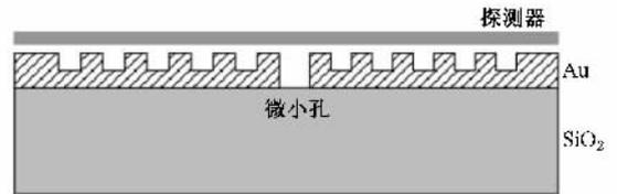
图5 二维计算模型结构示意图
