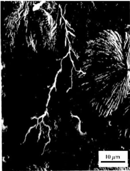
图 7 乙烯-丙烯共聚物中沿大晶块间隙生长的电树枝<sup>[1]</sup>
