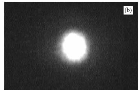
图 3 激光器工作在下稳区上边界且中心波长为 775 nm 时输出激光脉冲的图像 (a) 经过单色仪后 CCD 显示的图像 (b) 空间模式
