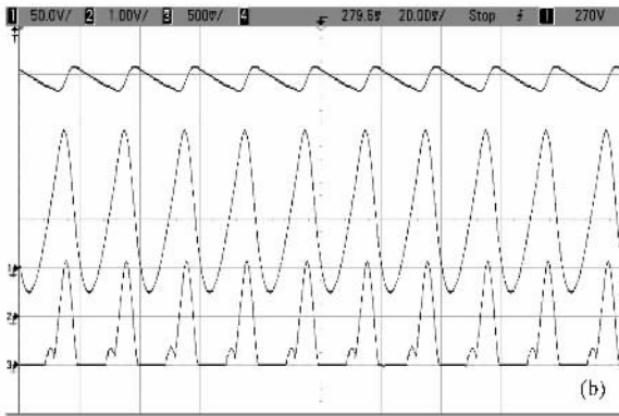
图 7 v_c (上), v_{ven} (中) 和 R_s i_{in} (下) 的实验波形, 横轴时间为 20 ms/格 (a) R = 400 \Omega, C = 470 \mu F , 周期 1 (b) R = 1 \text{ k}\Omega, C = 100 \mu F , 周期 2
