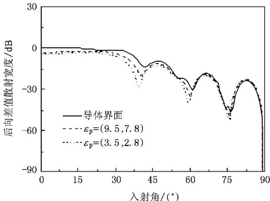
图 7 不同平板介电常数后向差值散射宽度的比较
