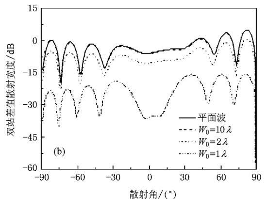
图 8 束腰半径对圆柱差值散射宽度的影响 (a) 后向 (b) 双站
