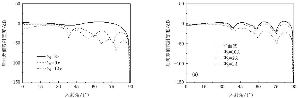
图 6 不同圆柱中心高度后向差值散射宽度的比较
