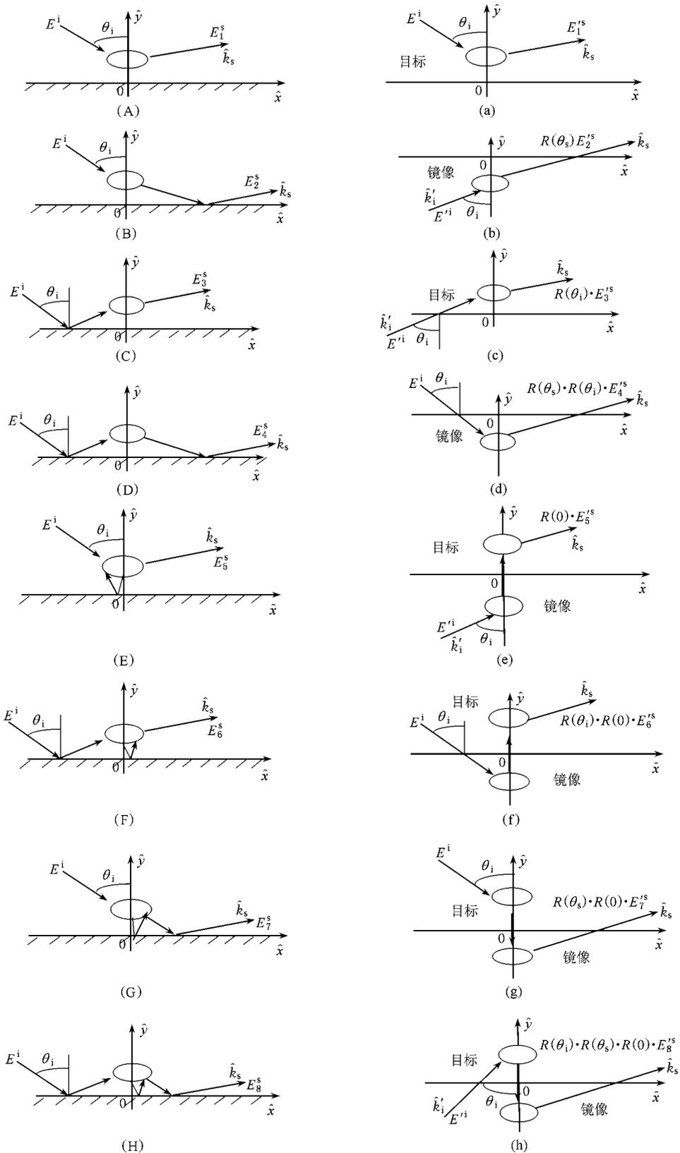
图 2 散射射线模型及等效散射模型的示意图 (A)–(H) 图形为散射模型 (a)–(h) 图形为等效散射模型
