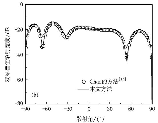
图 4 高斯波束入射时, 导体分界面上方圆柱目标的差值散射宽度 (a) 导体圆柱 (b) 介质圆柱
