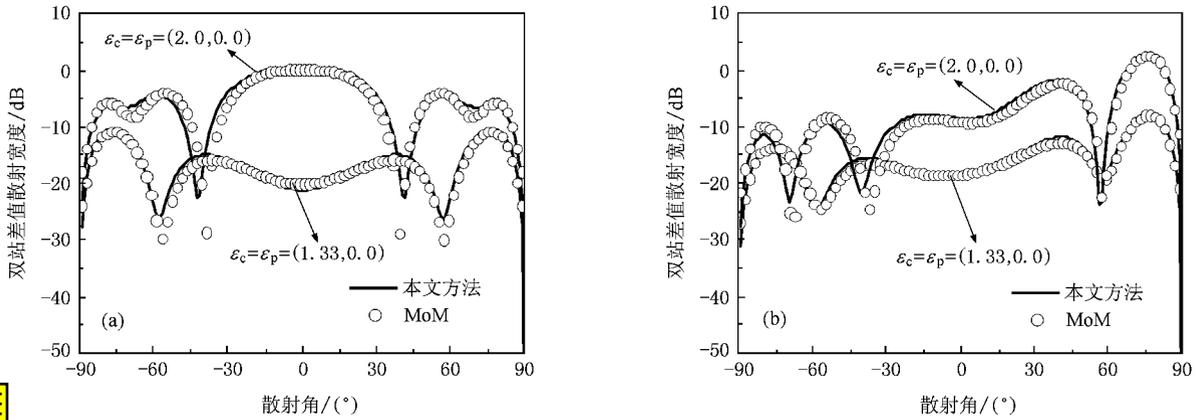
图 5 高斯波束入射时, 不同介质界面上方圆柱目标的双站差值散射宽度 (a)  $\theta_i = 0^\circ$  (b)  $\theta_i = 30^\circ$
