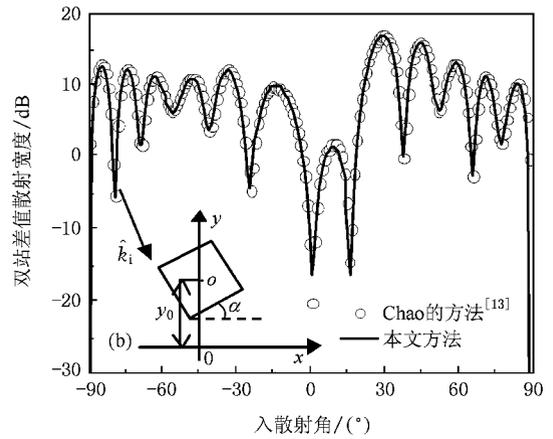
图 3 高斯波束入射时, 导体分界面上方方柱目标的差值散射宽度 (a) 后向 (b) 双站
