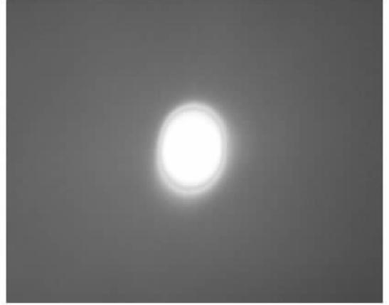
图 8 355 nm 激光的远场光斑图
