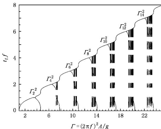
图 1 自由飞行时间  $t_f$  的分岔图( $t_f$  已被振动周期  $1/f$  约化)
