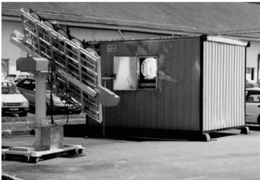
图3 1997年作者根据斜轴聚焦的原理制造出第一台新型太阳炉
