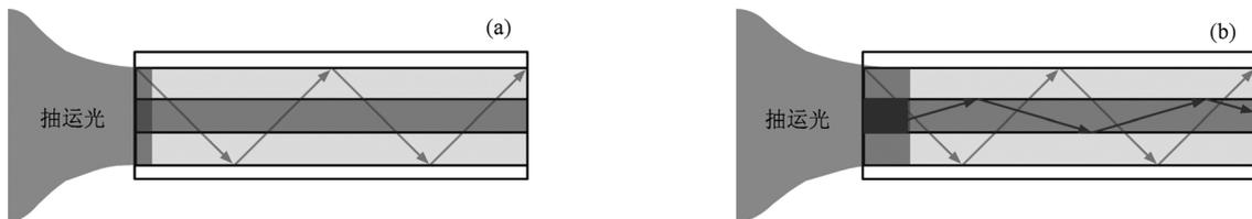
图10 抽运光在双包层光纤中的传输示意图 (a)抽运光在内包层中传输, (b)部分抽运光在纤芯中传输
