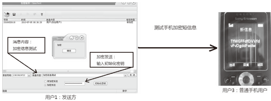
图 12 系统测试二: 向普通手机发送加密短信测试图
