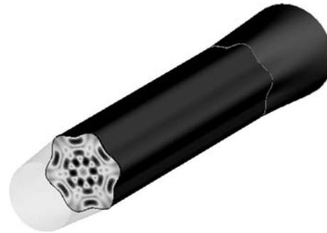
图 2 TE<sub>33</sub> 模横向截面图
