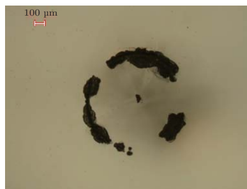
图 4 由于凸起形貌调制造成的后表面环状损伤与中心损伤
