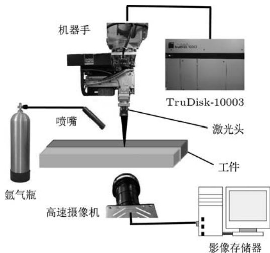
图1 激光焊接试验装置结构图
