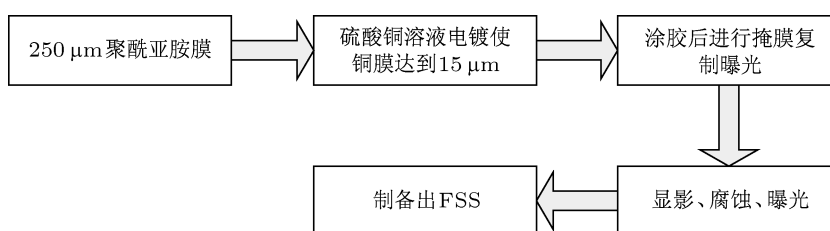
图8 FSS制备工艺流程
