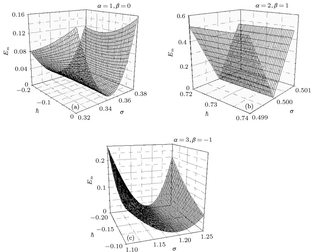
图 1 三种毛细流动形式, 前 5 阶级数解的平方残差  $E_m$  与  $\hbar$  和  $\sigma$  的关系曲线图 (a) 毛细上升; (b) 液滴扩展; (c) 恒定流
