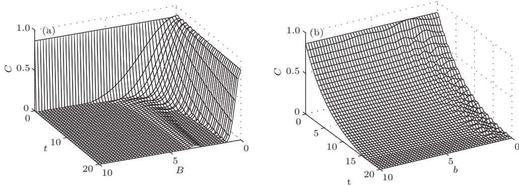
图 6  $D_x$  系统中量子纠缠随时间  $t$  和磁场  $B/b$  的演化 (其中  $J = 1, D = 2, \gamma = 0.02, \alpha = \pi/6$ ) (a)  $b = 0$ ; (b)  $B = 1$
