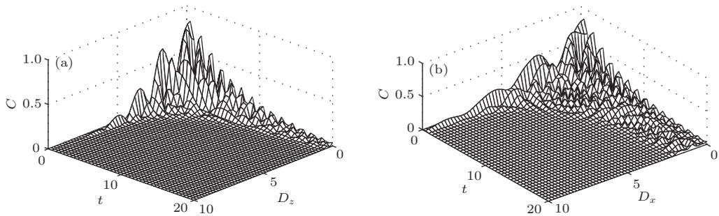
图 1 量子纠缠随时间  $t$  和 DM 相互作用  $D_{z/x}$  的演化 (其中  $J = 1, B = b = 0, \gamma = 0.02, \alpha = \pi/2$ )
