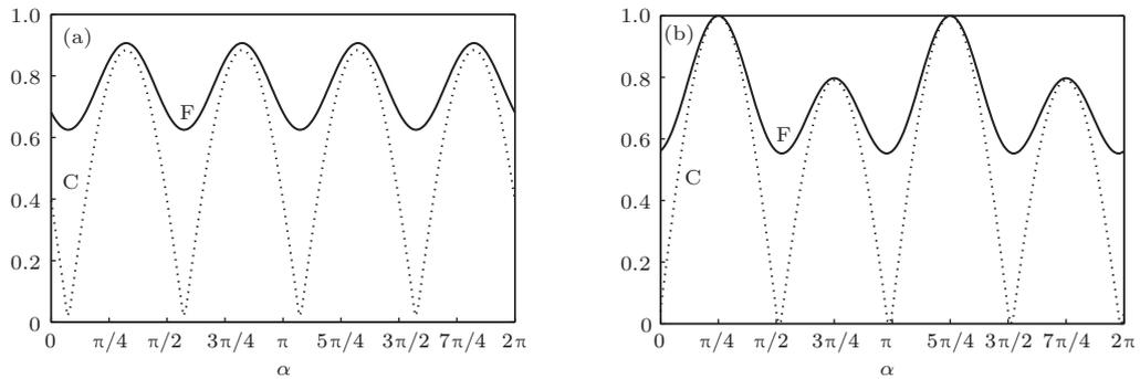
图10 保真度和纠缠随初始角度  $\alpha$  的变化 (其中  $\theta = \pi/3, \phi = 0, t \rightarrow \infty, J = 1, D = 0.2, B = 0, b = 0.5, \gamma = 0.02$ ) (a)  $D_z$  系统; (b)  $D_x$  系统
