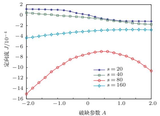
图 6 定向流  $J$  对势函数破缺参数  $A$  依赖性
