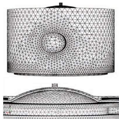
图 2 旋转靶系统计算模型网格划分
