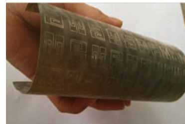
图4 柔性双频带超材料的加工结构实物图
