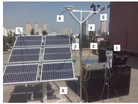
图 3 太阳能电池测温实验平台 1, 工控机; 2, 采集工作箱; 3, 贴片式 PT100(2个); 4, 支架; 5, 风速传感器; 6, 日射强度计; 7, 太阳能电池模组; 8, 双轴太阳能自动追踪台架
