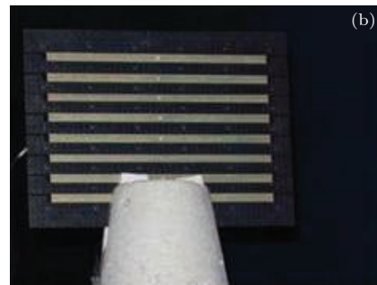
图14 波导缝隙阵列天线测试平台 (a) 暗室测试环境; (b) 待测样品固定
