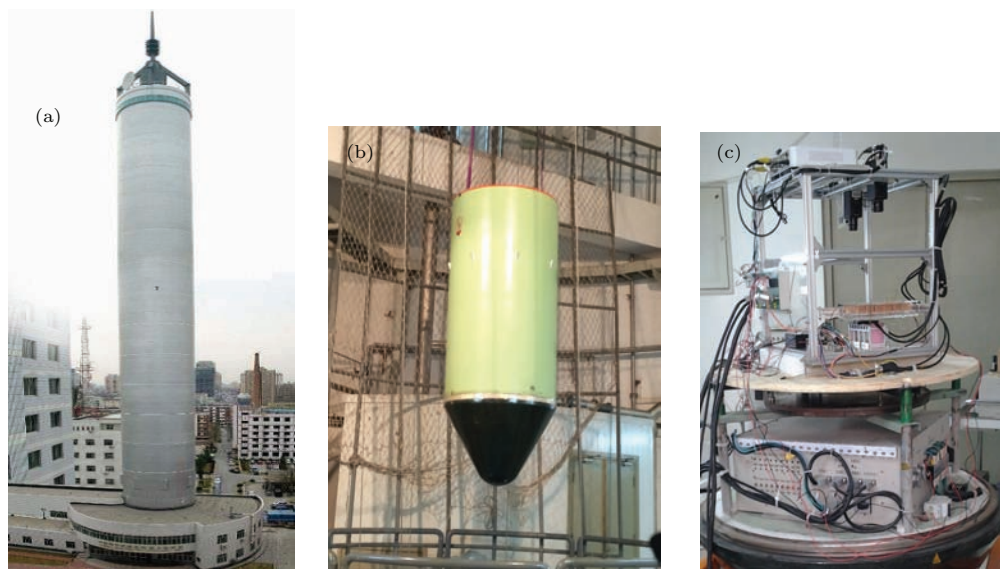
图1 (a) 落塔外观; (b) 落舱; (c) 实验装置
