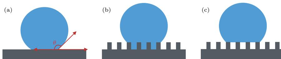
图3 (a) 接触角示意图; (b) Wenzel 态示意图; (c) Cassie 态示意图
