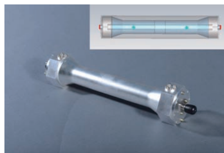
图1 测试样件及其内部结构
