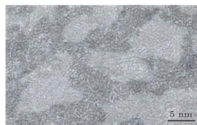
图3 高分辨电镜观察到的Pd<sub>425</sub>Ni<sub>75</sub>Cu<sub>30</sub>P<sub>20</sub>非晶合金的晶化区域和未晶化区域<sup>[8]</sup>
