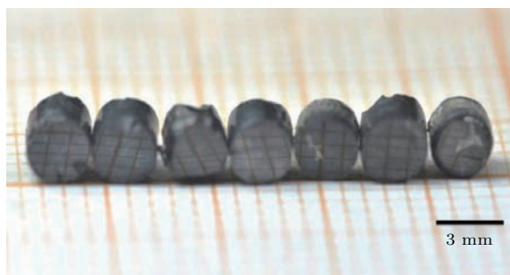
图4 批量烧结的纳米金刚石聚晶样品抛光后的光学照片 [48]
