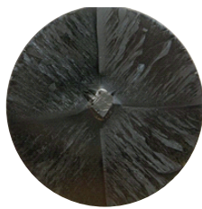
图 1 单畴 GdBCO 超导体宏观形貌 Fig. 1. The morphology of the sample.
