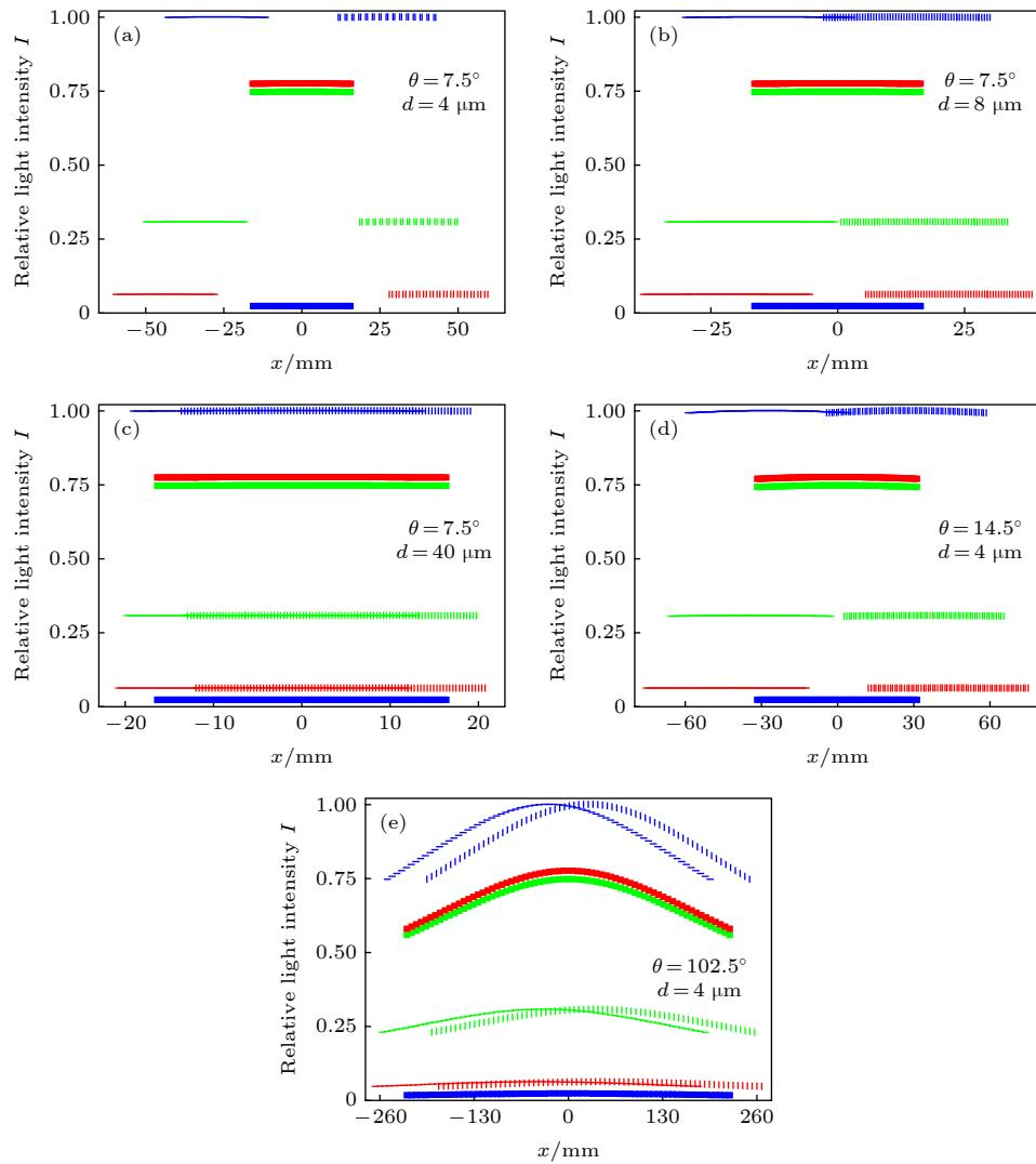
图 2 零级、 $\pm 1$  级三衍射级次的相对光强分布 (a)–(e) 入射光束锥角  $\theta$  和光栅周期  $d$  分别分别为  $(7.5^\circ, 4 \mu\text{m})$ ,  $(7.5^\circ, 8 \mu\text{m})$ ,  $(7.5^\circ, 40 \mu\text{m})$ ,  $(14.5^\circ, 4 \mu\text{m})$ ,  $(102.5^\circ, 4 \mu\text{m})$ ; 图中红色、绿色、蓝色线分别代表三原色的红光、绿光、蓝光; 零级、 $+1$  级、 $-1$  级分别用粗横线、竖短线、细横线表示
