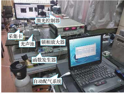
图2 光声光谱气体检测实验装置图
