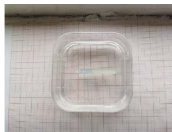
图 1 三段式键合 YVO 4 /Nd:YVO 4 /YVO 4 晶体照片
