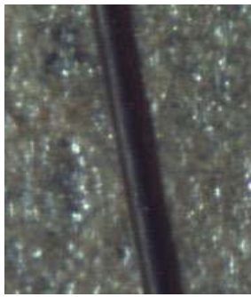
图 11 二氧化硅光纤上制备成的 TiNi 薄膜, 光纤包层直径为 125 \mu\text{m}
