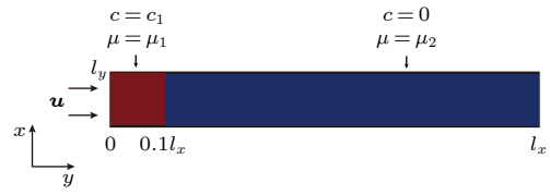
图 2 两平板间的互溶驱替问题初始状态示意图
