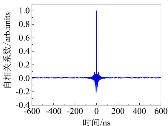
图 5 超晶格信号自相关曲线
