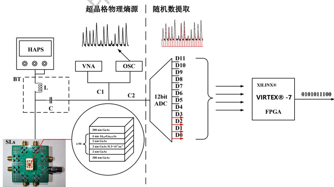
（彩色印刷）图2 超晶格高速物理随机数产生装置(HAPS，高精度电源；BT，T型偏置器；SLs，超晶格；L，电感；C，电容；OSC，示波器；VNA，矢量网络分析仪；ADC,模数转换器；FPGA，现场可编程逻辑门阵列)
