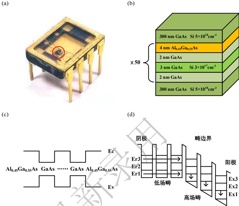
(彩色印刷) 图 1 超晶格 (a) 芯片实物图; (b) 结构示意图 (c) 能带 (d) 高低场畴和级联隧穿模型
