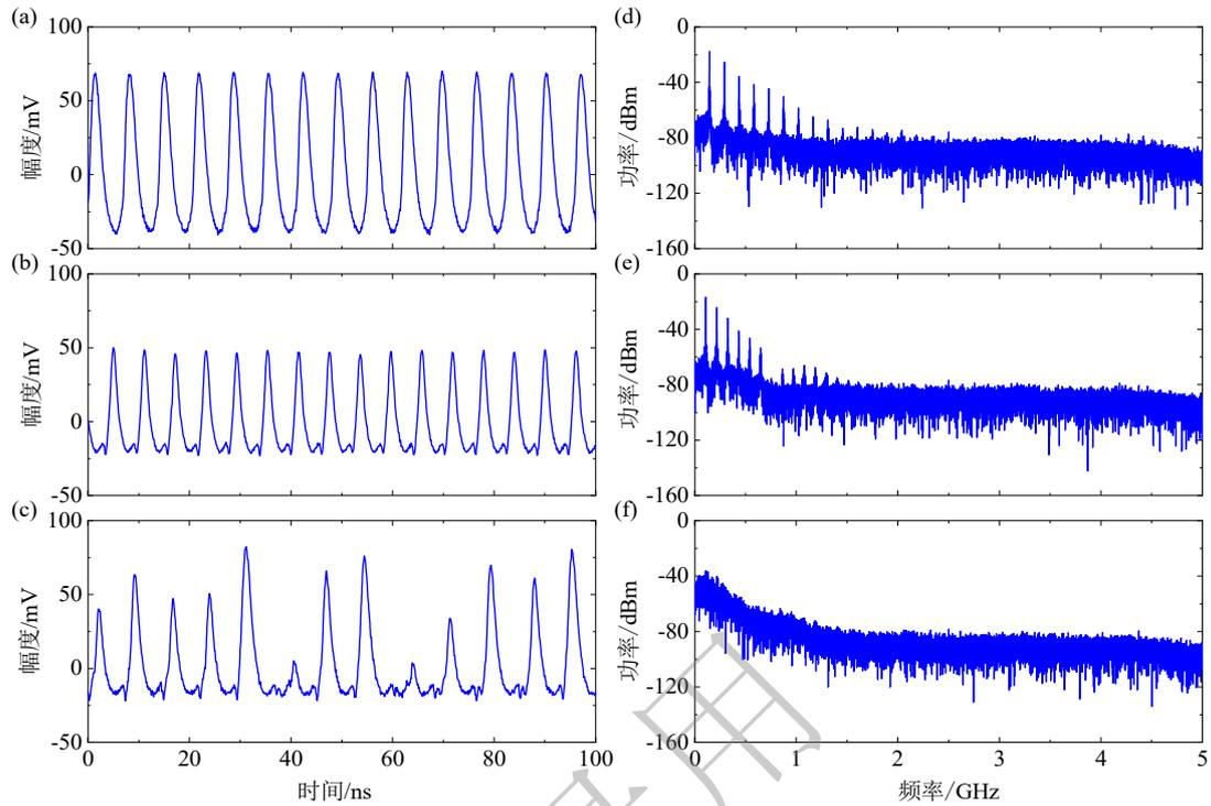
图 4 超晶格 (a) 单峰信号时序图; (b) 双峰信号时序图(c)非周期信号时序图; (d) 单峰信号功率谱; (e)双峰信号功率谱; (f) 非周期信号功率谱;
