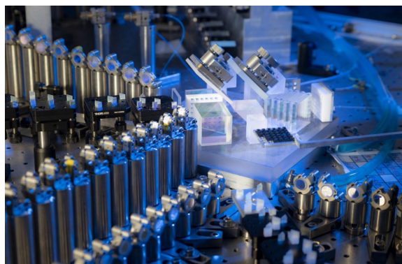
图 2 “九章”系列光量子计算原型机
