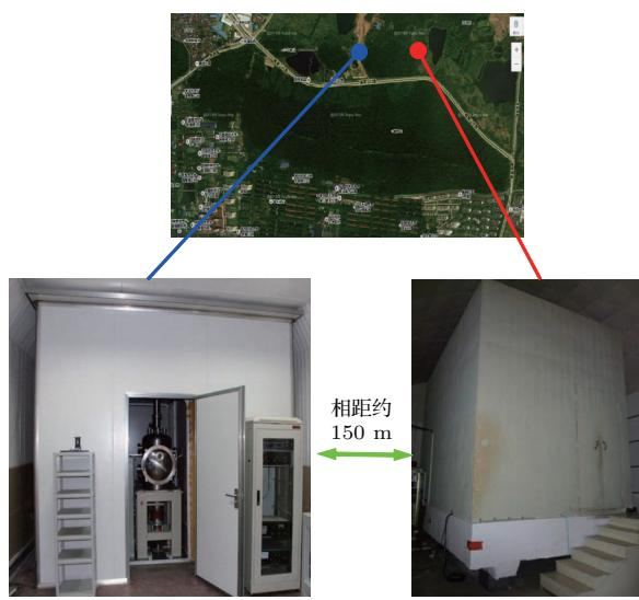
图 10 两套周期法测  $G$  装置
