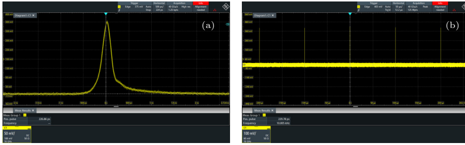
图 11 高速示波器测量的脉冲轨迹 (a) 500 ps/div; (b) 50 μs/div
