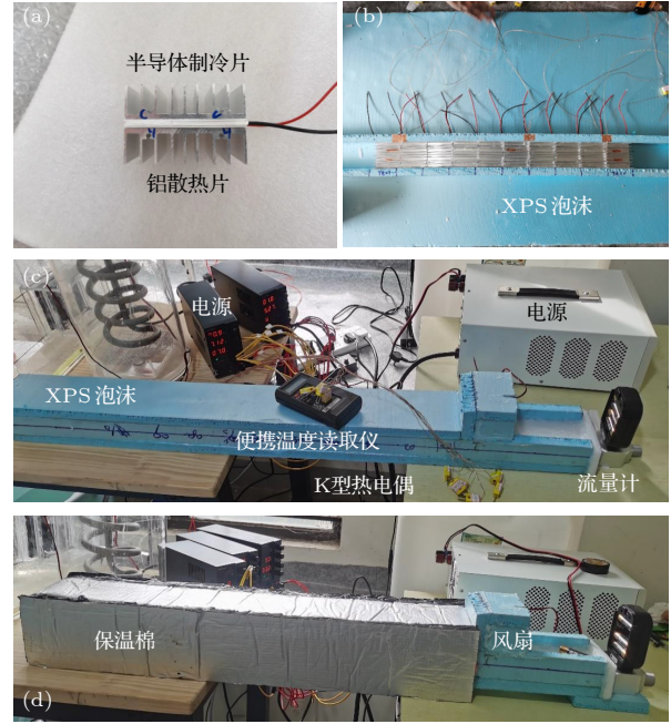
图 2 实验搭建测量平台实物图 (a) 单个半导体制冷片和换热片单元; (b) 多级半导体热电片组成通道; (c) 测量过程实物图; (d) 加厚保温层后测量实物图
