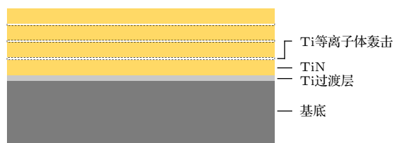
图2 厚 TiN 涂层的制备工艺示意图
