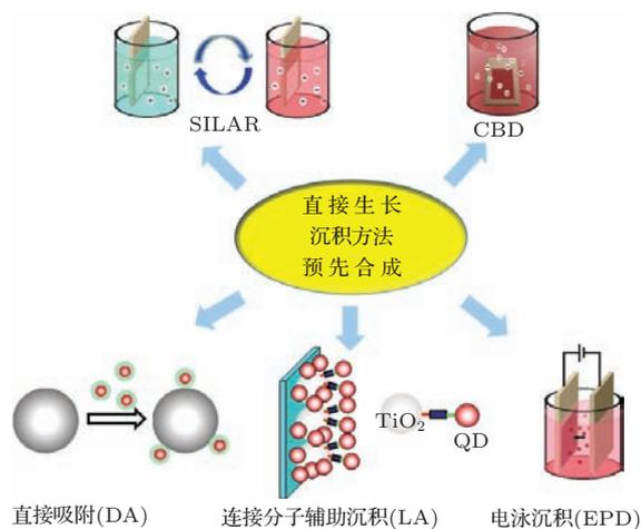
图2 量子点在TiO<sub>2</sub>上沉积方法
