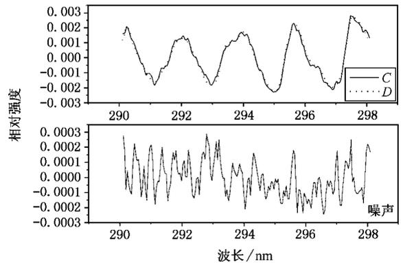
图5  $C$  是 2000 年 7 月 20 日 13 时 50 分的比值光谱, $D$  是浓度分别为  $0.011\text{mg}/\text{m}^3$ 、 $0.037\text{mg}/\text{m}^3$  和  $0.016\text{mg}/\text{m}^3$  的  $\text{SO}_2$ 、 $\text{O}_3$  和  $\text{NO}_2$  的差分吸收光谱之和,noise 是  $C$  减去  $D$  后的剩余光谱
