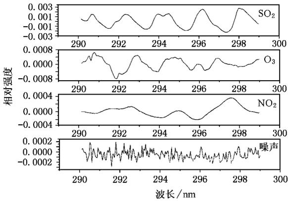
图3 浓度分别为  $0.010\text{mg}/\text{m}^3$ 、 $0.0295\text{mg}/\text{m}^3$ 、 $0.020\text{mg}/\text{m}^3$  的  $\text{SO}_2$ 、 $\text{O}_3$ 、 $\text{NO}_2$  的差分吸收光谱和噪声
