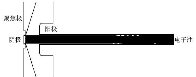
图 7 电子光学系统中电子注轨迹图
