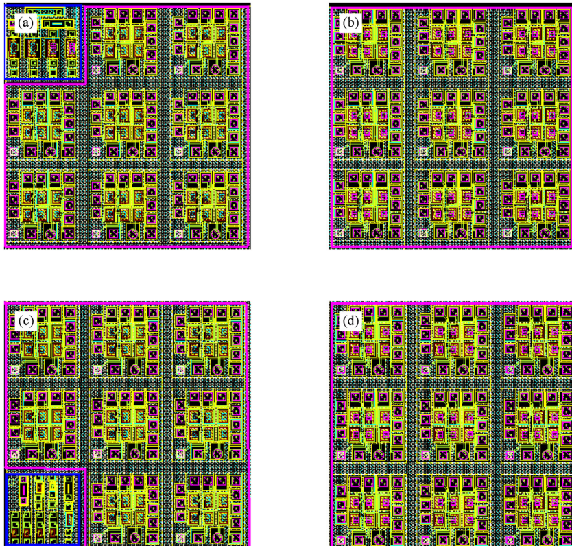
图 3 本文设计的三种加固型结构及常规结构的 n-p-n 晶体管版图 (a) 常规结构的 n-p-n 晶体管版图, (b) 发射结加固型结构的 n-p-n 晶体管版图, (c) 含有浓硼环结构的 n-p-n 晶体管版图, (d) 发射结加固 + 浓硼环结构的 n-p-n 晶体管版图
