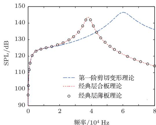
图 7 各向同性单层面板, 不加筋
