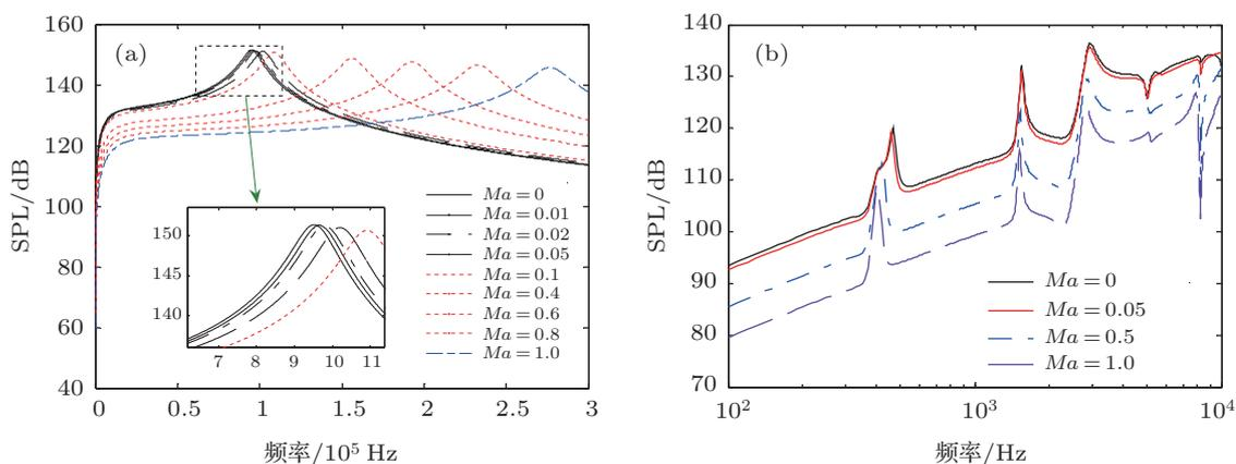
图 6 不同马赫数  $Ma$  下光滑平板和单向加筋板的 SPL 曲线 (a) 光滑平板; (b) 单向加筋板
