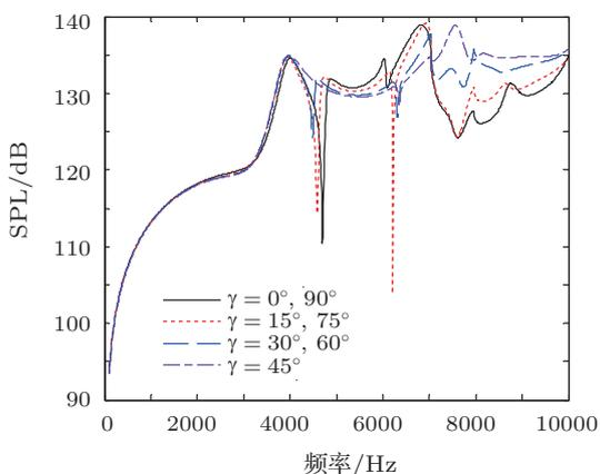
图 15 正交加筋层合板的 SPL 曲线
