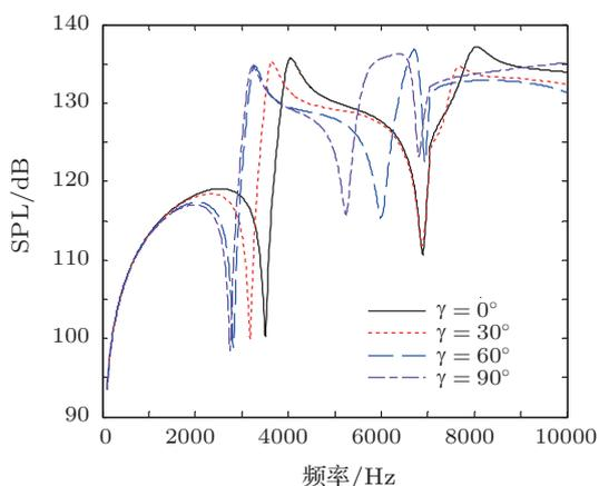
图 14 单向加筋层合板的 SPL 曲线
