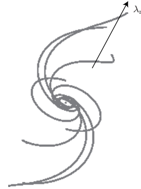
图 1 三维瞬时随(焦)点平动参考系中螺旋的流线
