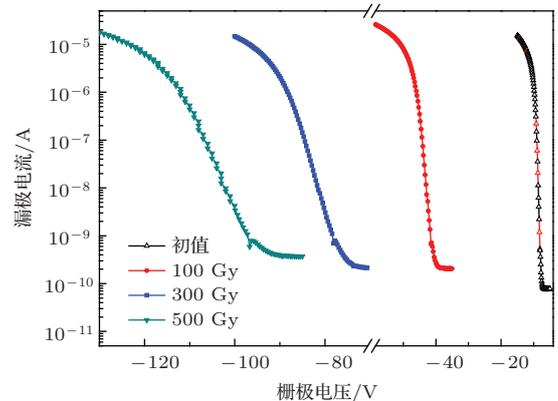
图2 栅控横向PNP双极晶体管漏极电流随栅压及总剂量的变化
